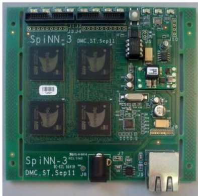
SpiNN 3: 4 SpiNNaker chips
